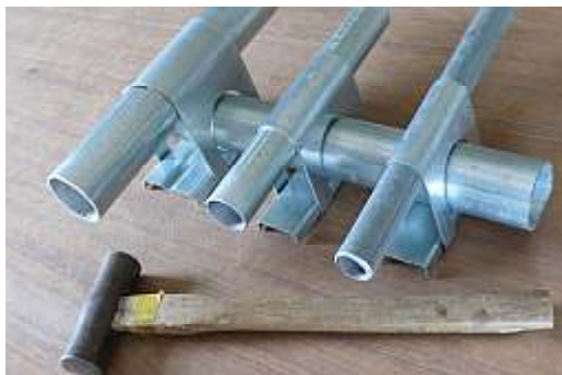
図6 足場用鋼管接合用の鋼板製十字棟用金具 左から48.6、31.8、25.4mmパイプ対応 （規格：左から48×48、32×48、25×48）
