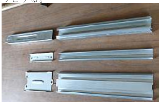
図10 平張型ハウスで使用したフィルム留め材 箱形(上)、シングル(中)、ダブル(下)
