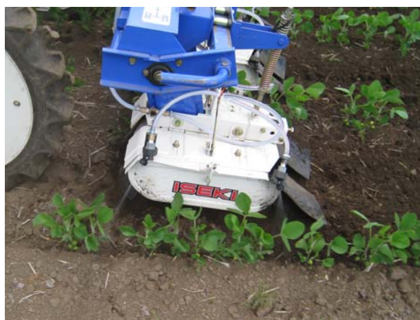
図5 前後のノズルの配置
