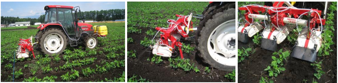
図3 開発した畑作用ハイブリッド除草機 (トラクタ型)
