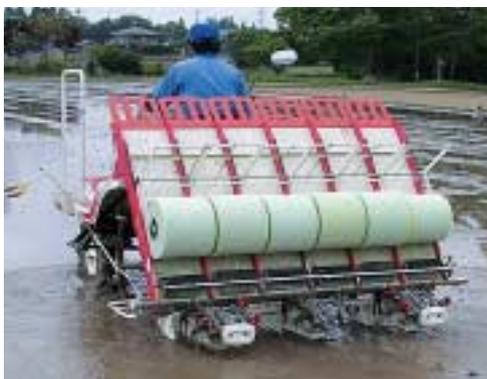
写真1 回転催芽種子シートを用いた田植機による直播作業風景
