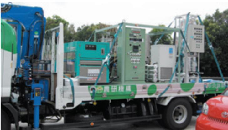
図3 運搬中の可搬型製造装置
