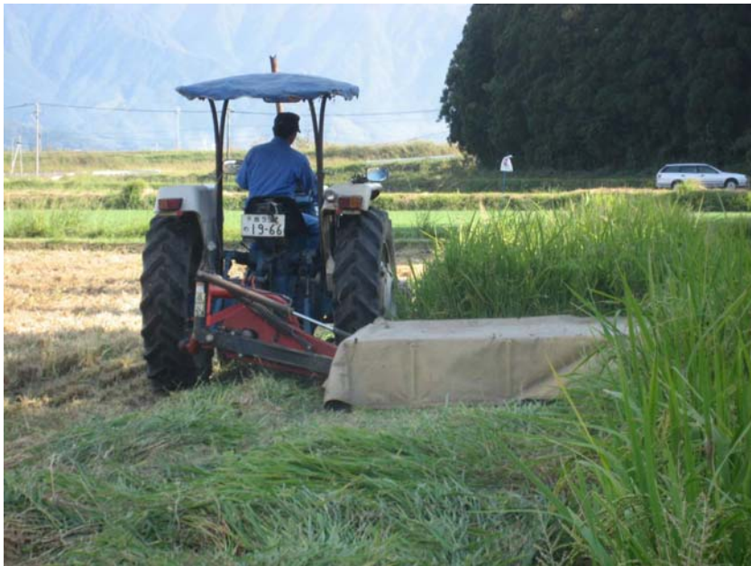
図 19 2回目イネのモアによる刈り取り（2006年10月25日，鹿屋市） 予乾しなくても，発酵品質の良いサイレージが調製できる。
