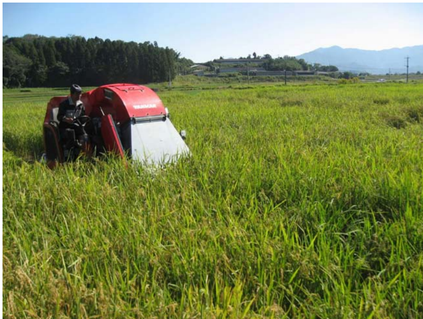
図 18 2回目イネの専用収穫機による収穫 (2006年10月25日, 鹿屋市) 収穫機が入れるように, 10月上旬から落水する
