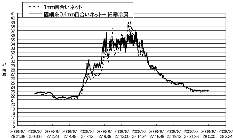
図 3 極細糸使用 0.4mm 目合防虫ネットと微細粒子細霧冷房の併用によるトマト育苗施設内のトマト草冠部温度の推移
