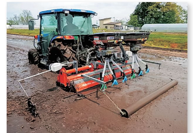
●湛水直播栽培技術「かん湛!」 浅く水をはった田に無コーティングの種もみをまく
