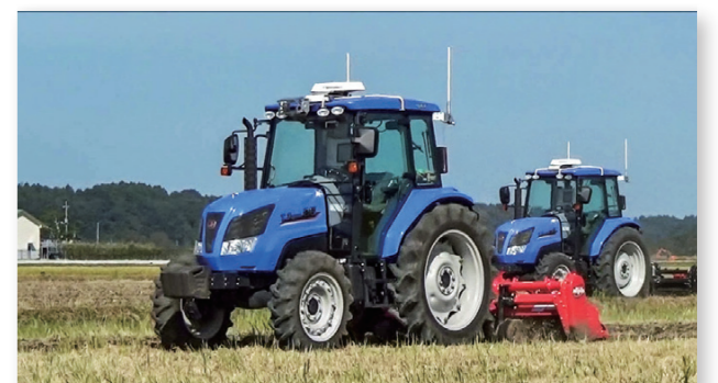
●2台のロボットトラクタによる耕うん作業（遠隔監視作業システム）
