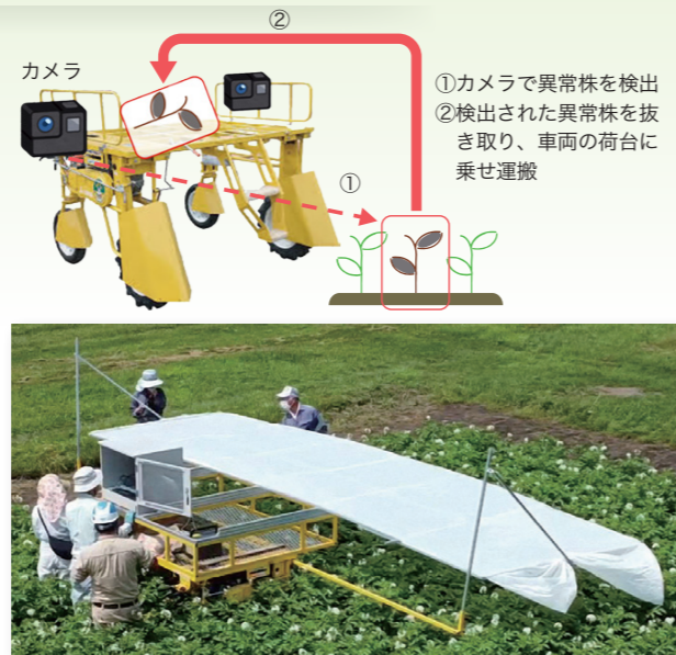
●異常株検出支援システム (上)システムの概要図 (下)試験ほ場での検出作業の様子
