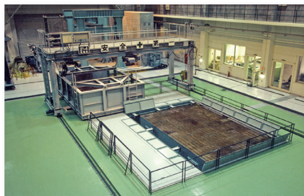
●三次元振動実験装置（1996年～現在） （左）落成時の様子。手前側の台が三次元に振動する （右）フィルダム（土砂や岩石を盛り立てて築いたダム）の液状化防止対策効果を評価。対策されている奥と手前は山型が保たれているが、対策なしの中央は崩れている
