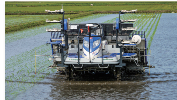
●現地実証試験で作業中の自動運転田植機 2022（令和4）年2月、農業機械メーカーから市販化
