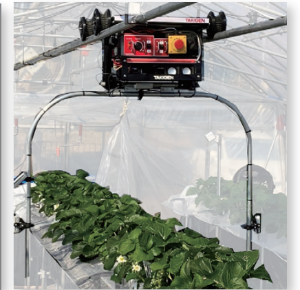
●自動生育センシングロボット 開花日、果実温度、作物形質を計測
