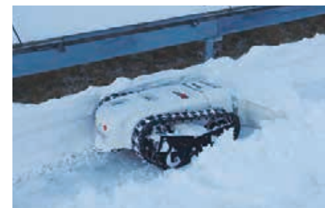
▲ユーザーの声で生まれた「除雪アタッチメント」に付け替えて、スイスイ雪かき
