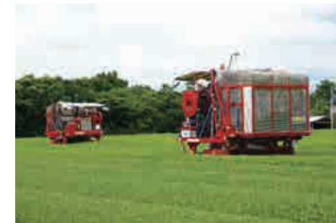
▲ロボット摘採機 作業員一人が2つのリモコンを使用して2台同時に摘採作業を行う
