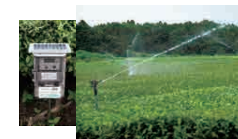
▲スマート散水装置 茶畑内に設置したセンサーのデータを元に自動で散水するシステムで、湿度によって自動で止水する
