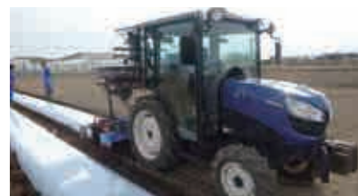
▲自動直進機能付き畝内部分施用機 畝立て、施肥、マルチ張りを同時に行う
