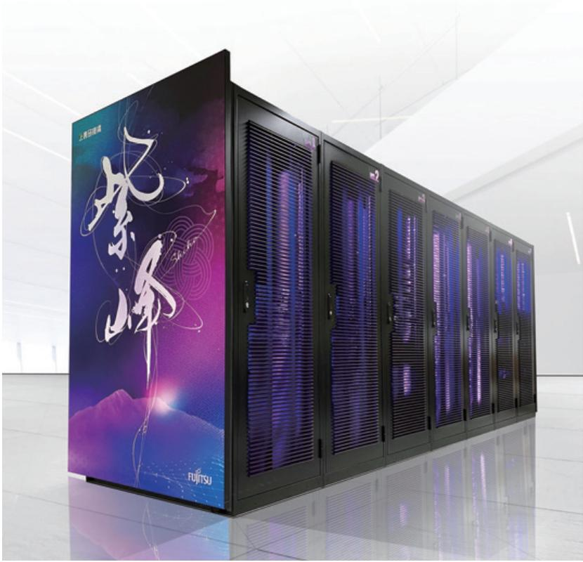
▲農研機構は農業 AI 研究用のスパコン「紫峰」の稼働を開始しました。従来の多くのスパコンと異なり、主力の演算装置に GPU (Graphics Processing Unit) を用いた、機械学習や画像解析に適した仕様が特徴です。人工知能 (AI) とデータを活用した最先端の研究を加速し、農業界や産業界で真に役立つ技術を開発することで、農業・食品産業の成長産業化を目指します。
