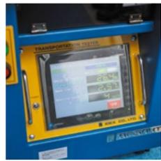
想定するトラック輸送の条件により、振幅や振動数を調整できます。
