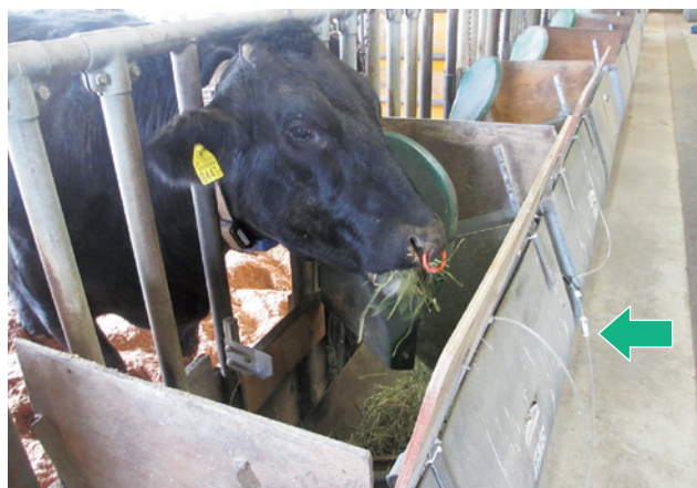
図6 肥育牛の飼槽での呼気ガス測定 矢印:ガス採取分析ライン
