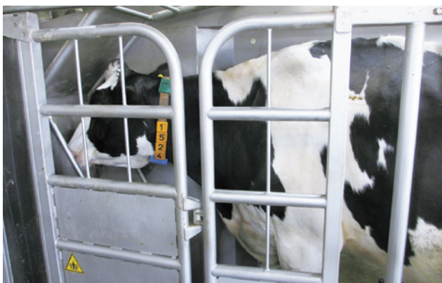
図2 搾乳ロボット内で搾乳中の乳牛 エサ箱(飼槽)の中のガスをポンプで吸引し、別室のガス分析計で濃度を分析する。
