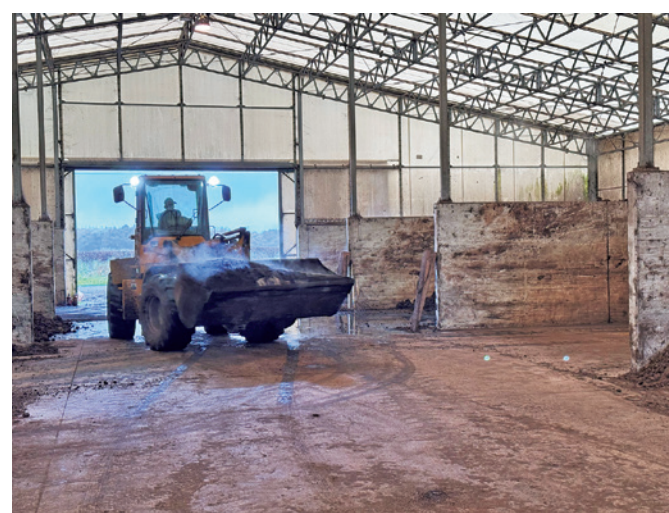
図2 ホイールローダによる堆肥切り返し作業
