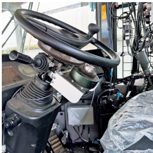
図4 キャビン内に後付けされたアクチュエータ類
