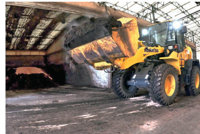
図6 堆肥センターにおける堆肥化ロボット実証試験の様子 壁に衝突しないよう移動経路を指定するため、台形に堆肥が積み込まれるが、オペレータによるホイールローダ作業時間は68%削減可能。
