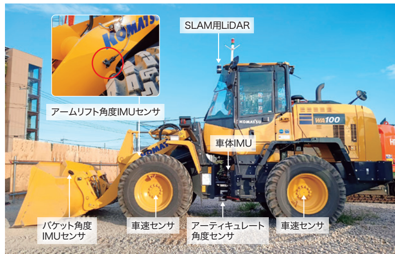
図5 自律駆動化に必要なセンサ類
