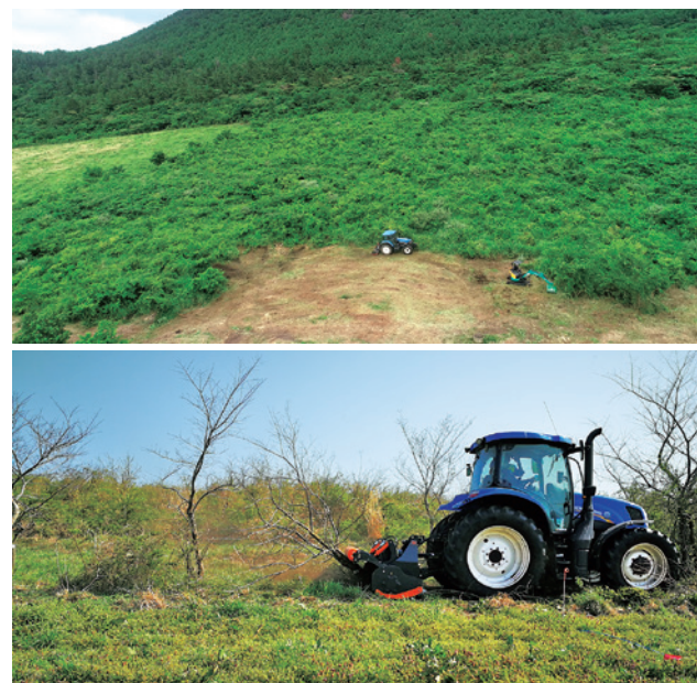
図1 木本植物を含む広大な実証地で不要な植物の除去を行うフレールモア
