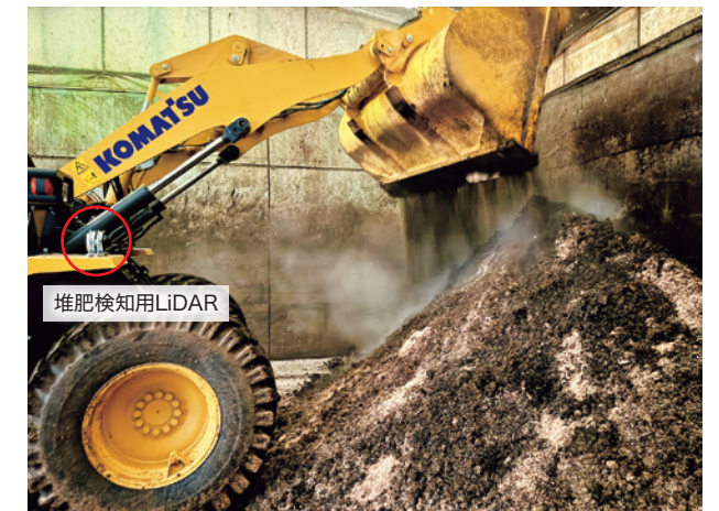
図7 堆肥化ロボット実証試験における堆肥の積み下ろし動作の様子
