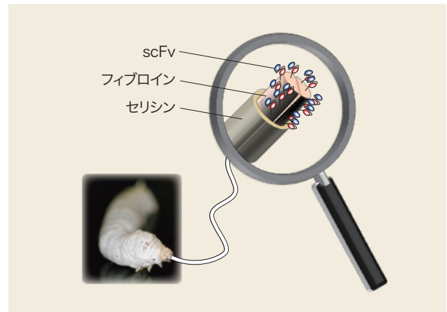
図3 一本鎖抗体とフィブロインL鎖の融合タンパク質からなるアフィニティーシルク
