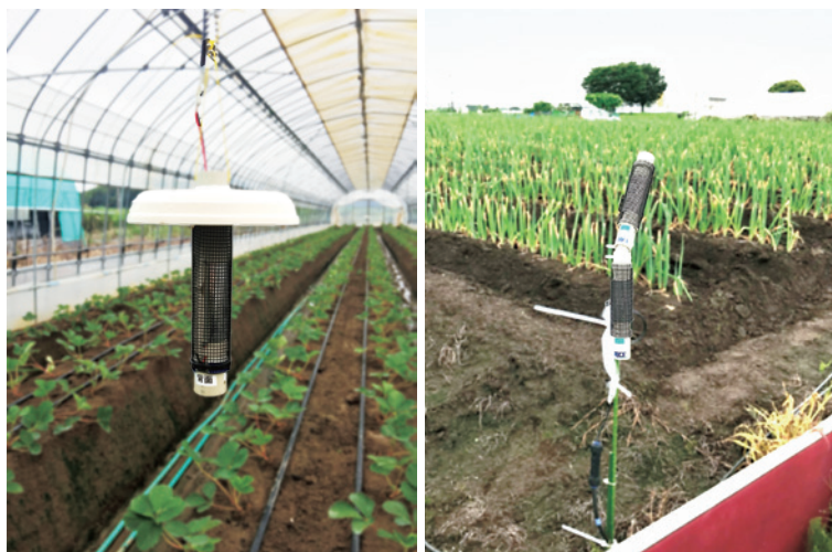
図4 有機圧電フィルムの特性を利用して開発した円柱型の超音波スピーカー イチゴ栽培施設（茨城県つくば市・佐藤武史氏）のパイプ資材から吊るした場合（左）とネギ露地ほ場（千葉県松戸市・平川嘉一氏）に「くの字型」で設置した場合（右）
