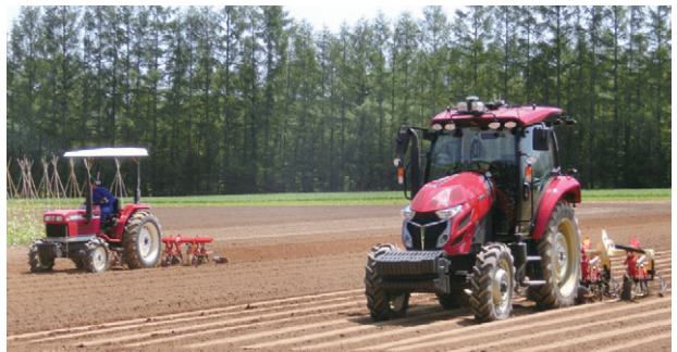
ロボットトラクタによる中耕（左：有人走行、右：無人走行）播種時の走行軌跡データを用いた無人作業
