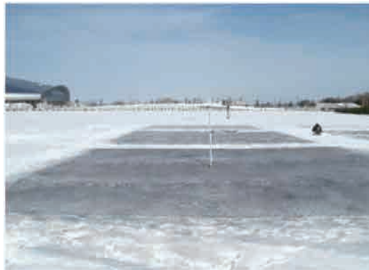
写真. 開発した融雪材試験の様子
