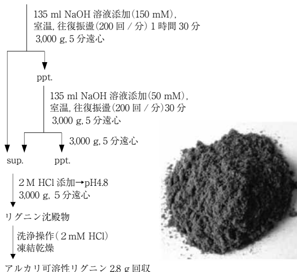
図3 エリアンサス糖化後残渣からのASL回収フローチャート, 及び回収リグニンの形状
