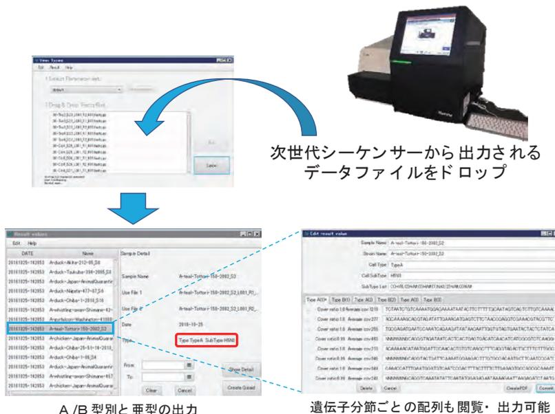
図. 次世代シーケンサー出力データのFluGASを用いた解析フロー
