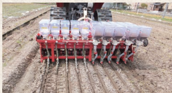
不耕起V溝播種機での播種 （乾籾6kg/10a設定）
