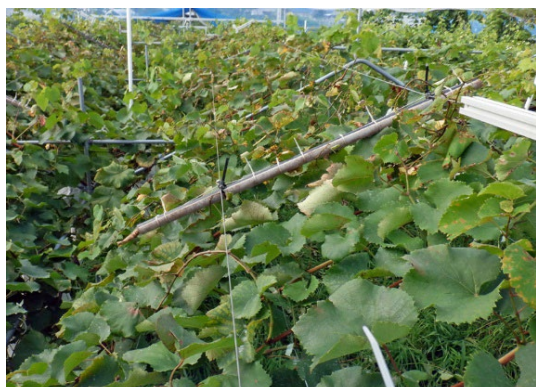
新梢管理装置の接触棒の動作状況
