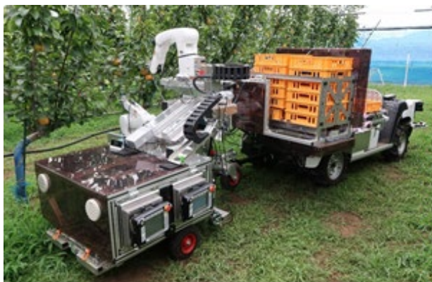
収穫中の収穫ロボット
