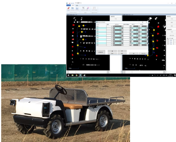
自動走行車と作業設定アプリケーション
