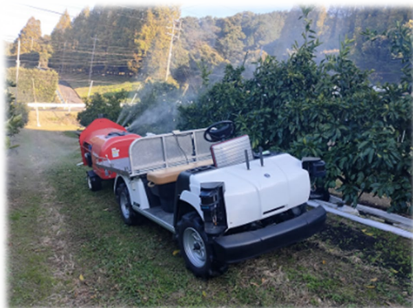
自動防除機による薬液散布
