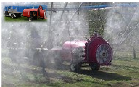
自動走行車牽引式防除機による自動防除
