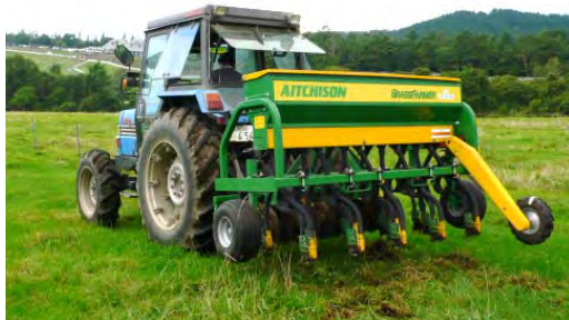
更新に利用したシードマチック 草地に溝を切り、そこに種を落とす仕組み
