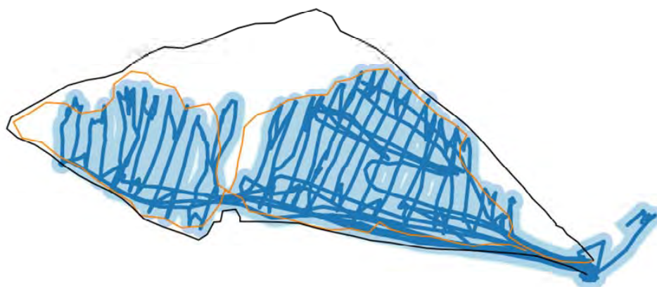
図 1-3-15 GPS ガイダンスの有無による作業軌跡の比較. 携帯型 GPS にて記録。黒線は圃場外周、オレンジは施肥作業可能だったエリア.
