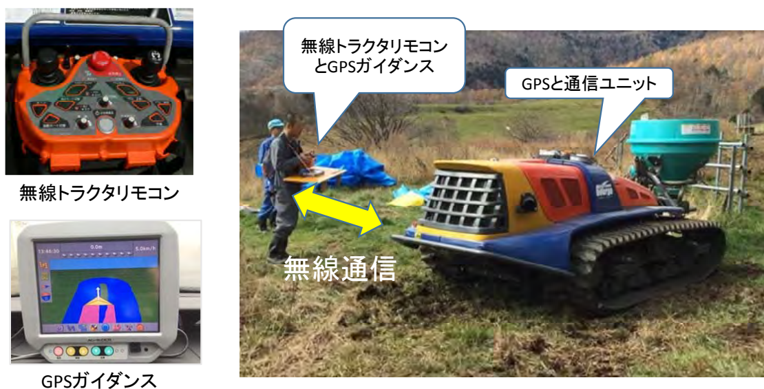
図 1-3-14 傾斜地無線トラクタと傾斜地無線トラクタと GPS ガイダンスの接続.
