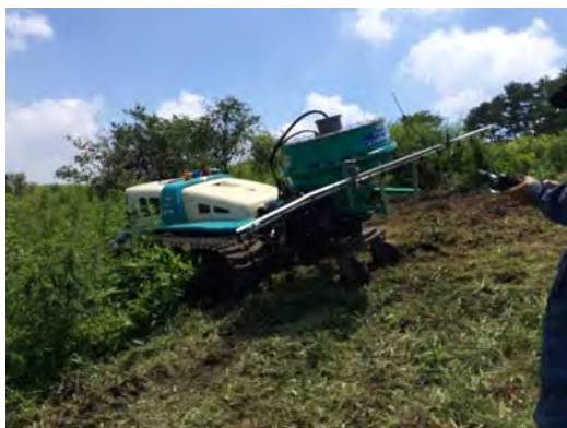
② スプレーヤによる除草剤散布
