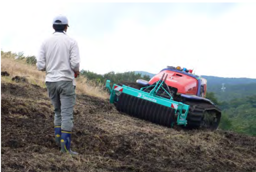
図 1-3-11 鎮圧作業の様子.
