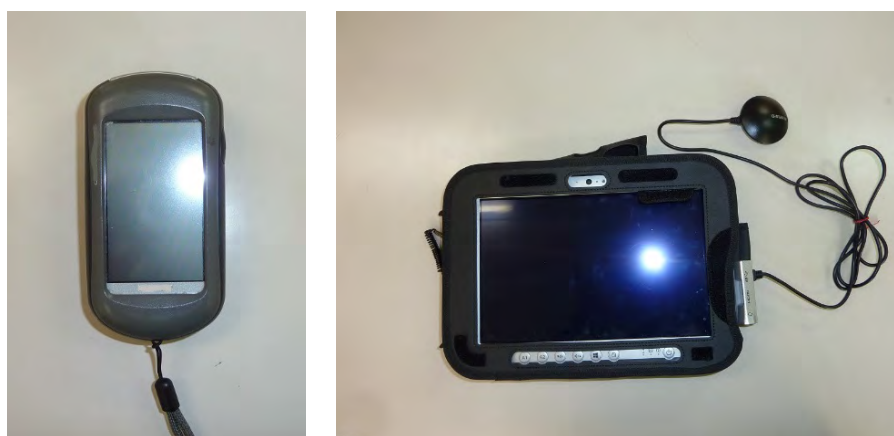
図 1-2-10 携帯型 GPS（右）と外付け GPS 受信機を取り付けたポータブル PC.
