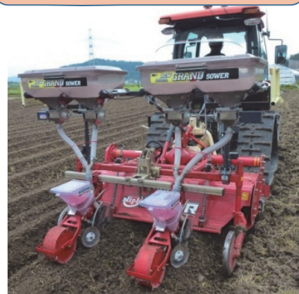
施肥ホッパが増設された耕うん同時畝立て播種機 写真は10L用ホッパ2個を増設した例
