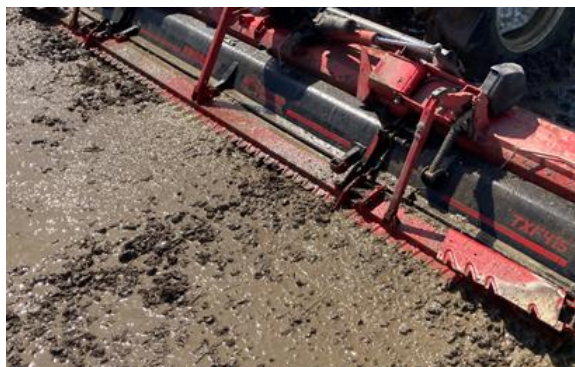
図2-3-3. 代かき時の埋め込みの様子 (浅水・2工程)
