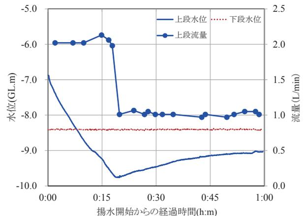
Fig.11 上段のみ揚水時の水位と揚水強度変化
