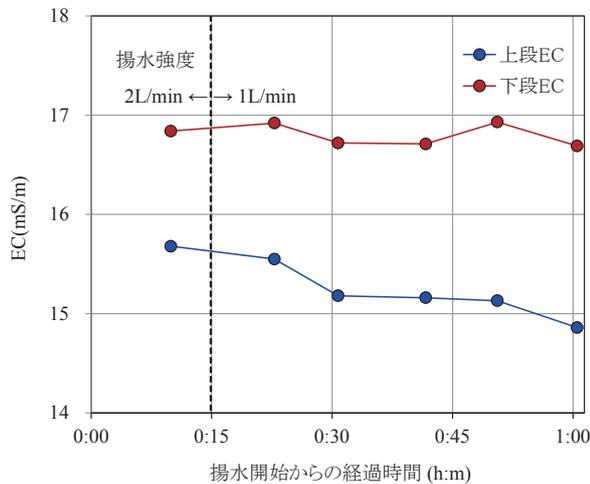
Fig.8 取水試験中の EC 変化
