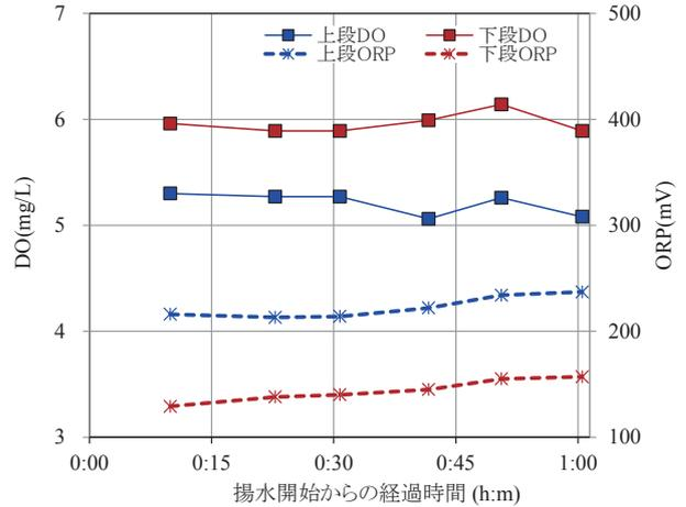
Fig.10 取水試験中の DO および ORP
