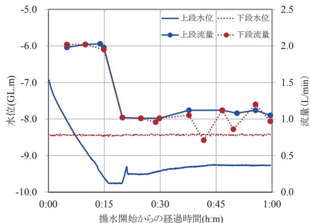
Fig.7 取水試験中の水位と揚水強度変化
