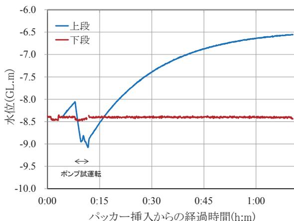
Fig.6 パッカー挿入後の水位変化
