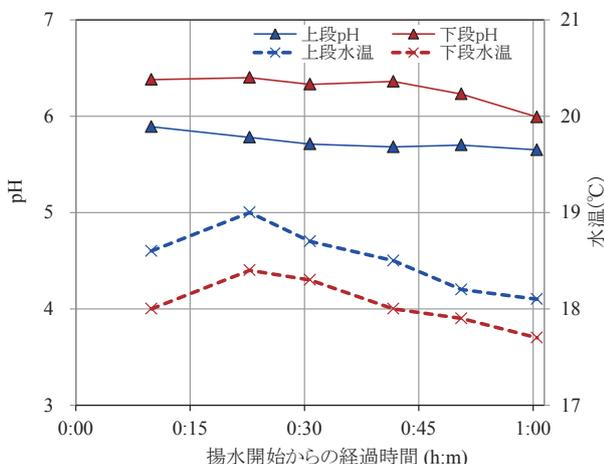
Fig.9 取水試験中の pH および水温変化
