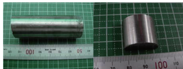
(a) 軸の外観 (b) 切断後の軸
