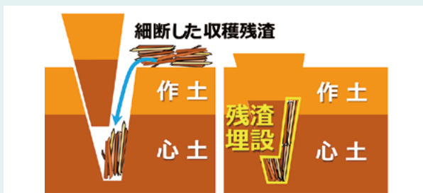
図：カットソイラーの外観・施工方法（左） 及び資材埋設状況（右）
