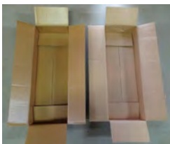
図 通常の段ボール（右）と機能性段ボール（左） 機能性段ボールは内側にプラスチックフィルムが貼り付け加工されているため光沢がある。
