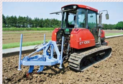
穿孔暗渠(施工)機カットドレーン
