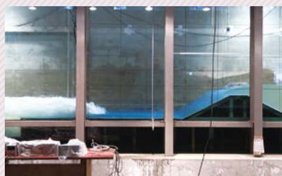
水理模型による津波の減勢工法の評価
