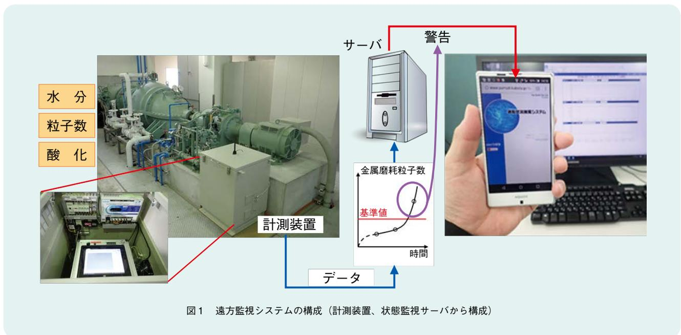
図1 遠方監視システムの構成（計測装置、状態監視サーバから構成）
