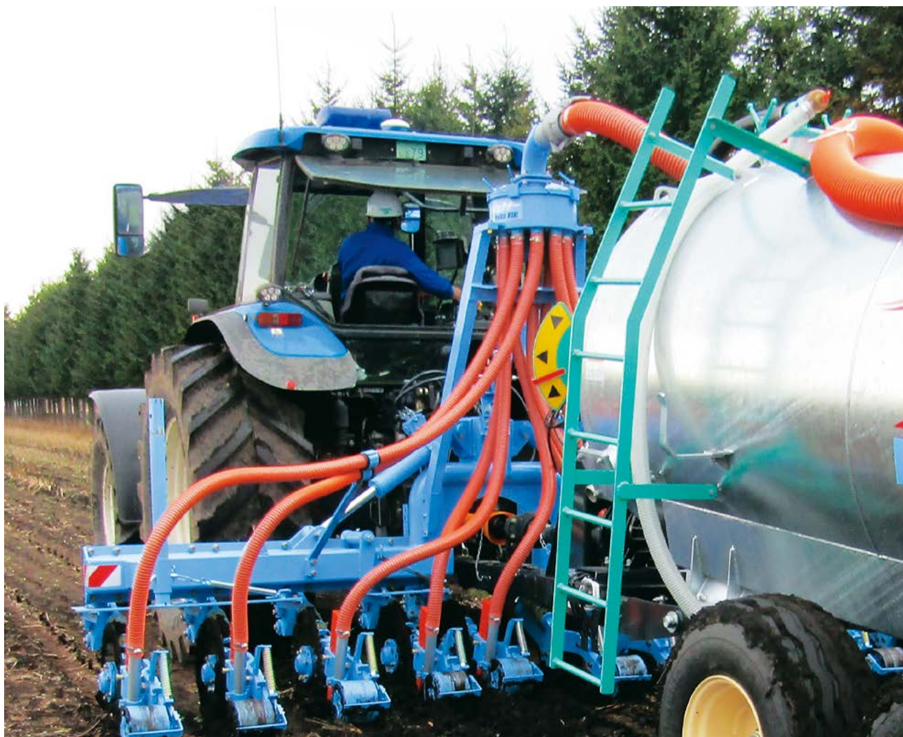
スラリーインジェクタによるメタン発酵消化液の施用
