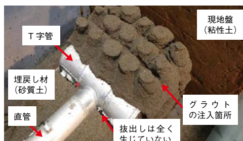
図4 実験後に地盤を開削した状況(固結工法を適用した場合)
