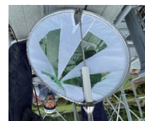
回収網（φ75mmのボールバルブから投入可能）
