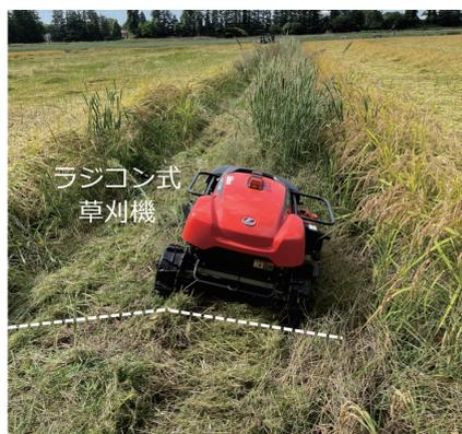
▲図 2 既存のラジコン式草刈機を用いた三角畦畔の除草試験例
