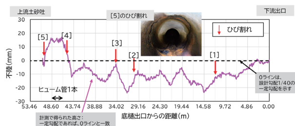
▲図 3 縦断勾配変化点とひび割れ発生位置との関係
