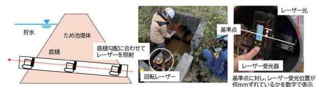
▲図 2 底樋縦断勾配の測定原理
