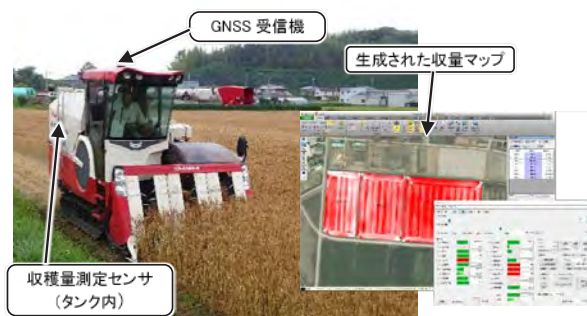
図1 収量コンバインとマッピングシステム
