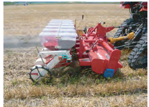
実証試験に使用した近中四農研開発機(左、中央)市販乾田直播機(右)の大豆播種の様子
