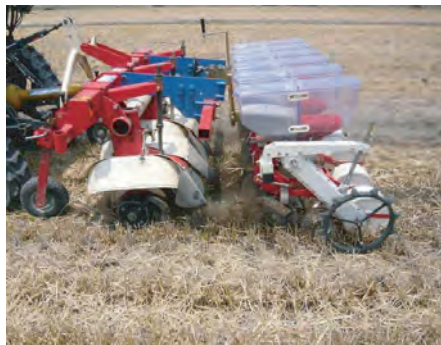
実証試験に使用した近中四農研開発機(左、中央)市販乾田直播機(右)の大豆播種の様子
