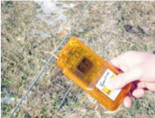
写真11 電圧測定用テスター
