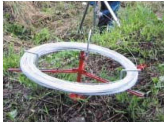
写真16 高張力鋼線の繰り出し器
