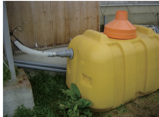
堆肥化過程で発生するアンモニアを硫酸溶液に通して硫酸液肥として回収
