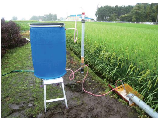
簡易施用装置（マリオット式）による硫酸液肥の施用
