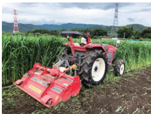
写真 4-8 細断なしのすき込み(ロータリー 30 馬力)「元気ソルゴー (カネコ種苗)」
