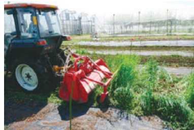
写真 5-8 フレールモアでの細断、すき込み
