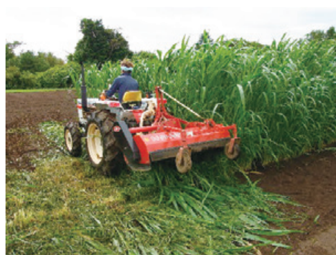
写真 4-7 フレールモアによる細断 「つちたろう (ジャンボ) (雪印種苗)」
