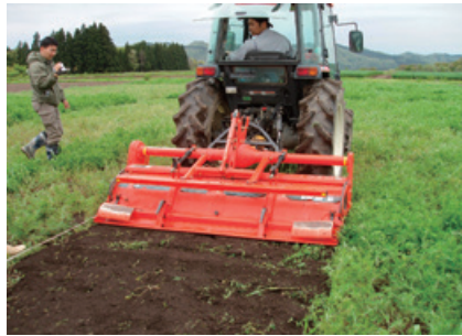
写真 7-8 ロータリーによるすき込み
