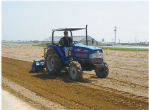
写真 8-4 ロータリーによる覆土作業
