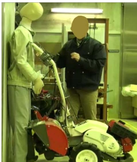
図2 ハンドル上方向の負荷に対する動作確認試験
