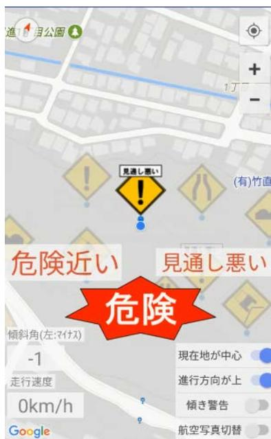
図3 停止中でも近傍にあれば警告（走行速度：0km/h）
