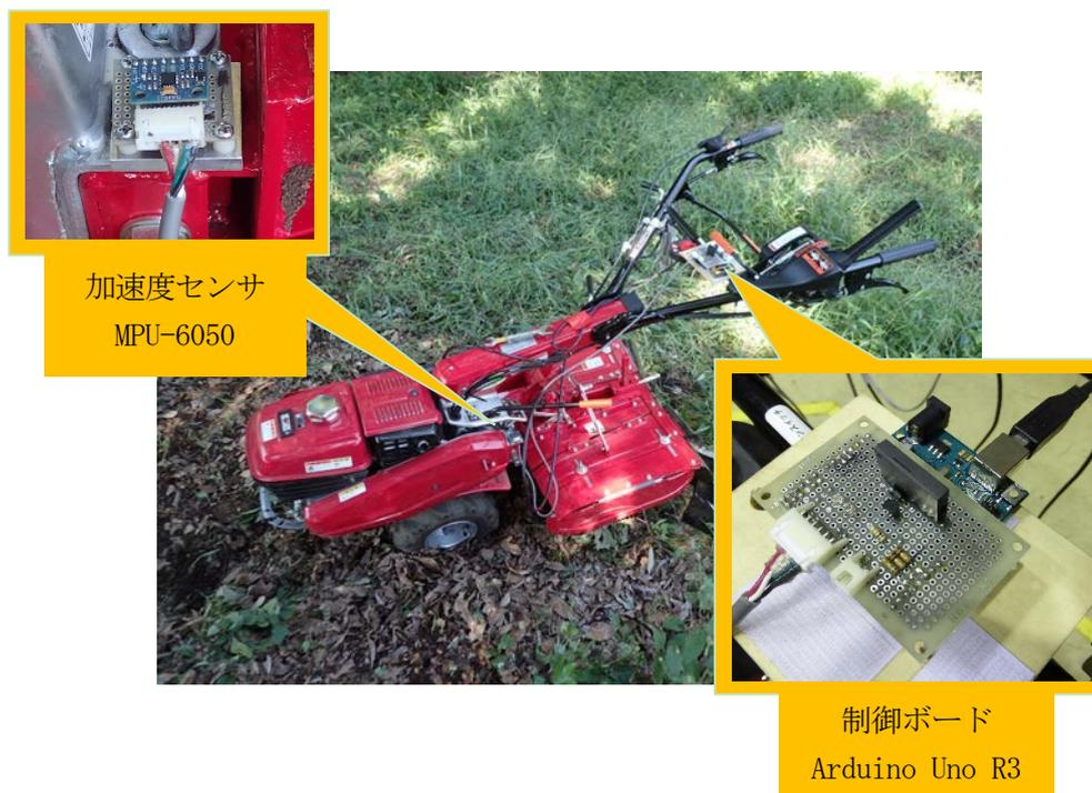
図3 供試した歩行用トラクタ、加速度センサ、制御ボード
