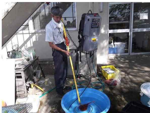
図 2-3. エレクトロフィッシャーによる処理
