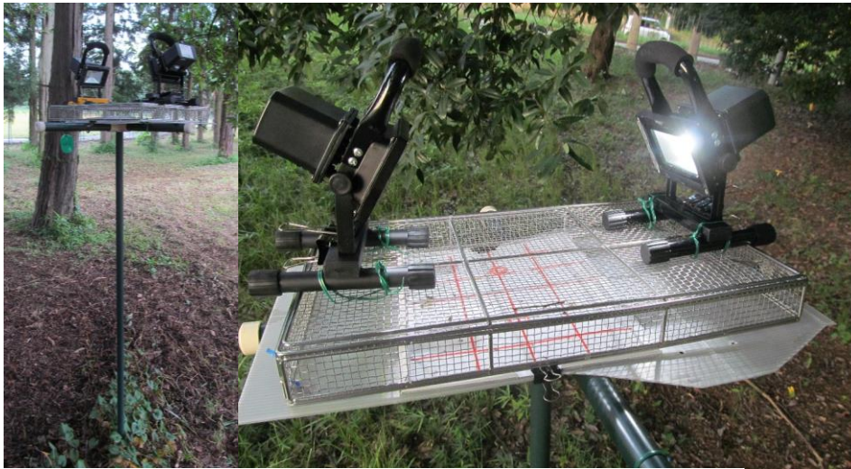
図 3-19. 白色 LED を用いたトラップの設置
