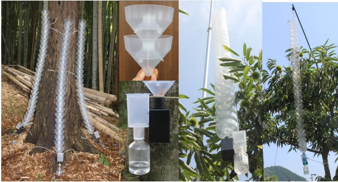
図 3-7. カシナガキクイムシ用トラップの構造と設置状況
