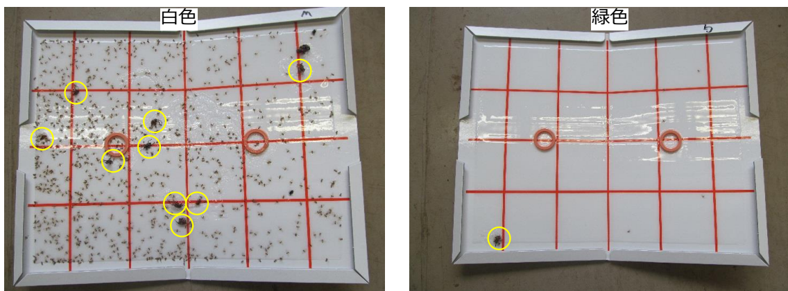
図 3-18. LED を一晩点灯したときのトラップ結果 左：白色 LED 光源 2 台使用、右：緑色 LED 光源 4 台使用 一晩点灯した結果、黄色の○は捕殺された成虫を示す。
