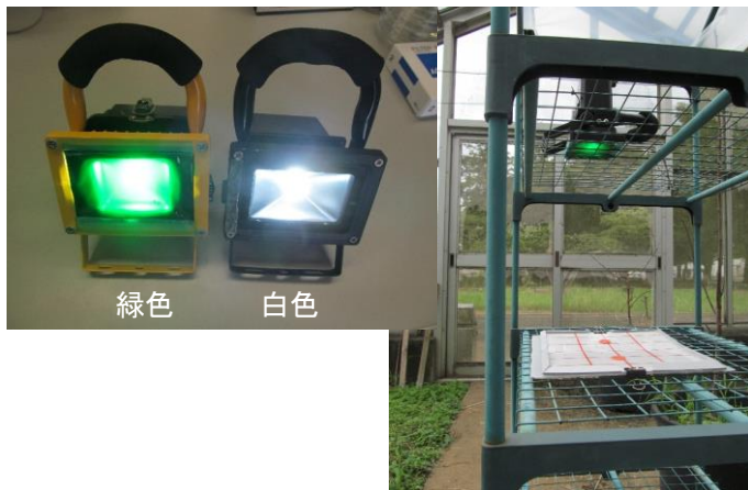
図 3-17. LED 光源 (左) と誘引試験方法 (右)
