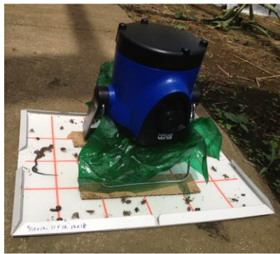
簡易型緑色光トラップ (白色LEDランタンに緑色セロファンを被せ、粘着板に乗せたもの)
