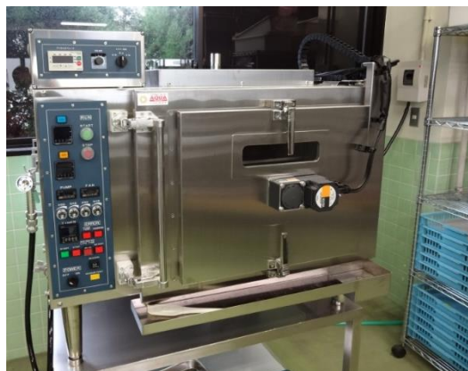
図 2-2. 蒸気処理装置
