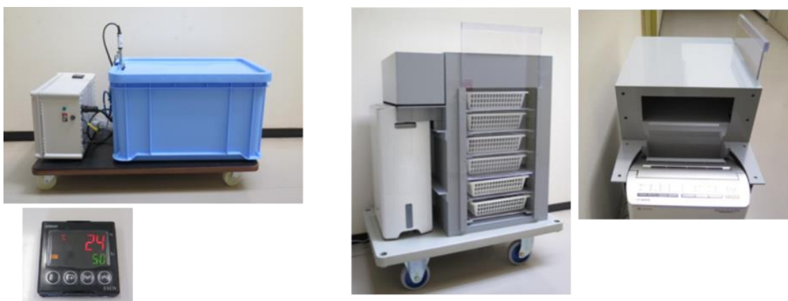
図 2-1. 試作した温湯処理装置 (左) と乾燥装置 (右)
