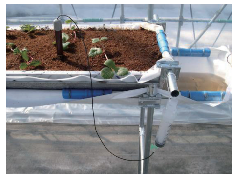
図13 培地内養液を採取してEC値をモニタリング
