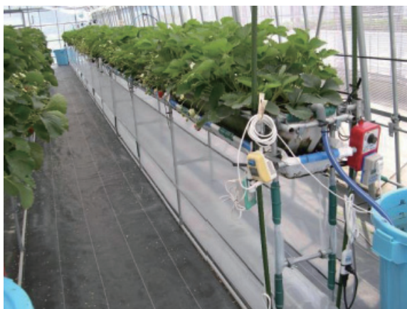
図4 改良送風システムの設置状況
