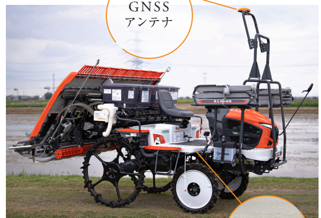
両正条制御技術を搭載した試作機
