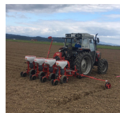
写真1 高精度播種機による大豆播種の様子
