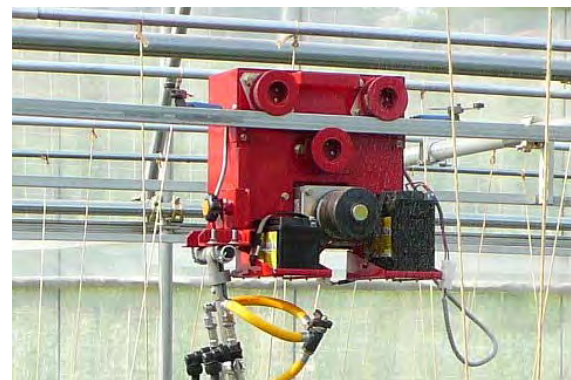
図 11 レール式薬剤自動散布装置
