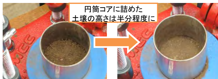
図4 土壌締固め機による土壌の圧密化の効果
