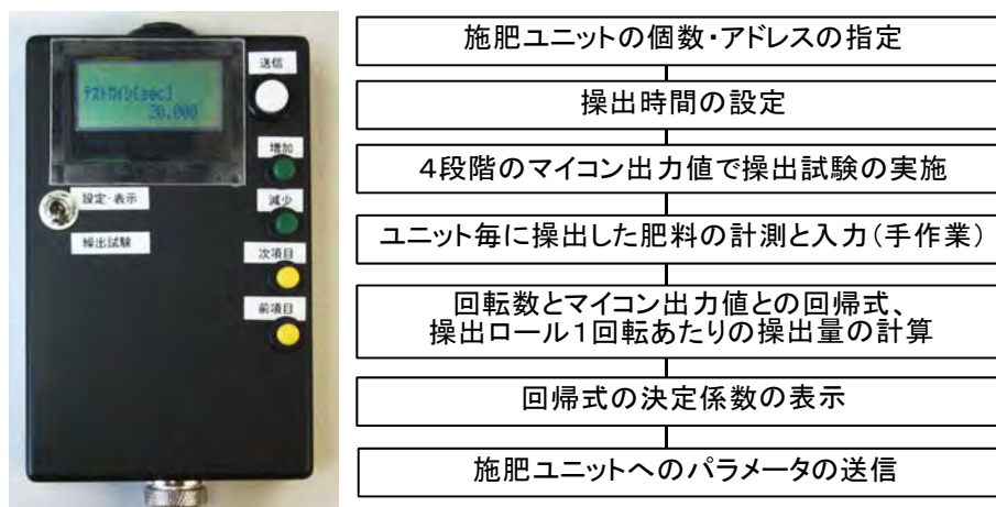
図3 パラメータ簡易設定ECU概要と操作の流れ
