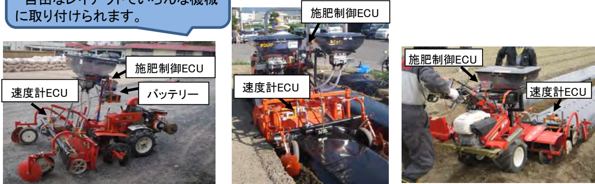
歩行型畝立て施肥マルチャ (近中四農研試作機)
