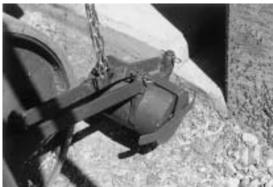
写真 23 壁面踏圧ローラ Photo 23 Side compression roller
