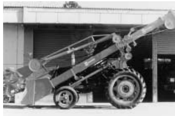
写真8 サイレージアンローダ (トラクタマウント型) Photo 8 Silage unloader (Tractor mounted type)
