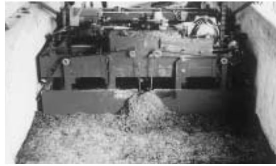
写真 39 試作 2 号機によるグラスサイレージ取り出し作業 Photo 39 Grass silage unloading work by prototype 2
