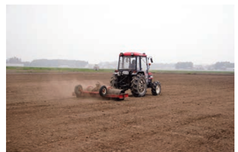
写真3：カルチパッカによる播種後の鎮圧（作業幅2.5m）
