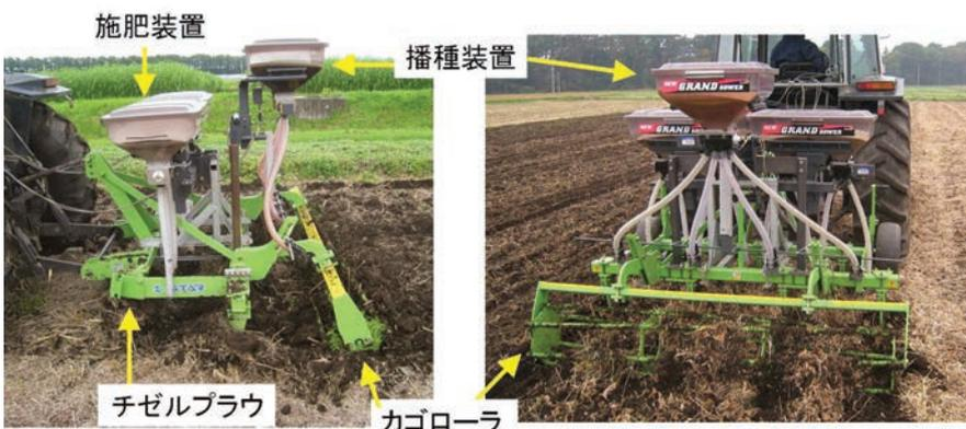
図1 / 開発した簡易耕同時施肥播種機
