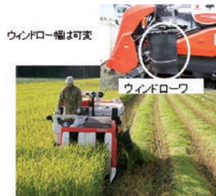
図1/自脱コンバインによる稲の刈倒し作業
