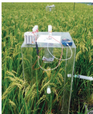
写真/透明なチャンバーを使って水田から出るガスを採取する
