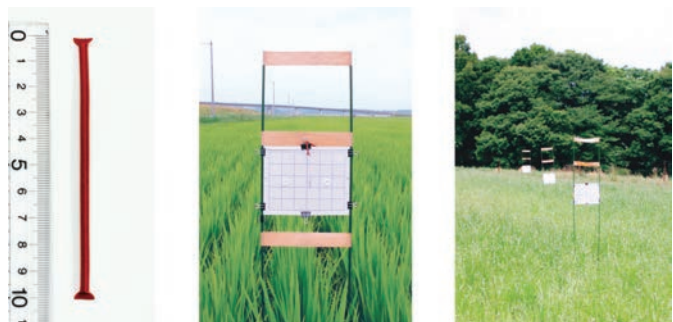
図2 / フェロモン製剤(全長10cm)(左)と水田(中)、牧草地(右)に設置したトラップ
