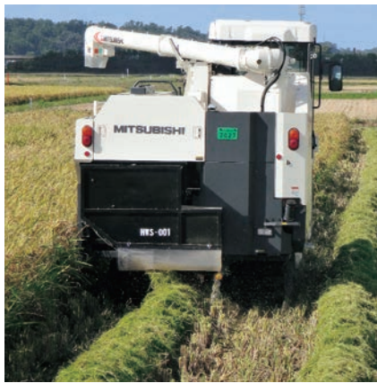
写真/汎用コンバインによる稲の収穫 稲わらは刈り株上に排出されます。
